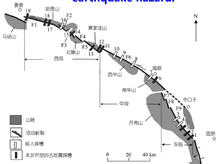
图 1 海原断裂带的几何结构、分段和探槽分布图
